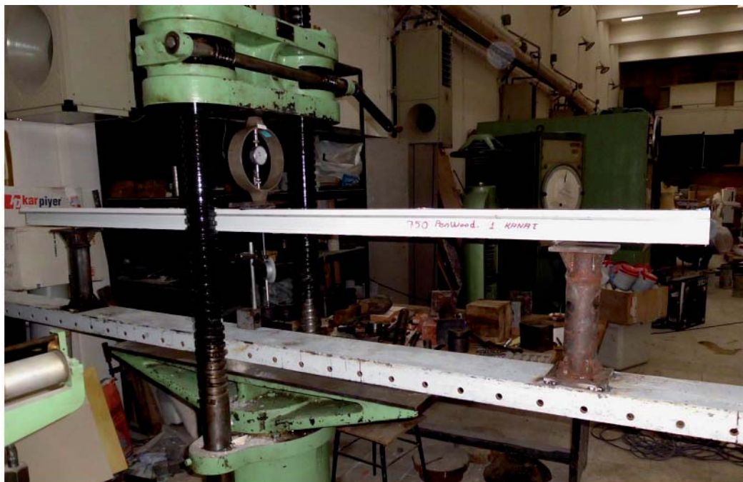
Foto 13. Máquina de test de doblado
