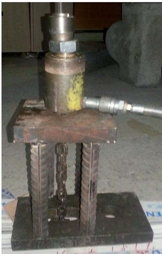
Foto 9. Máquina para la prueba de destornillado
